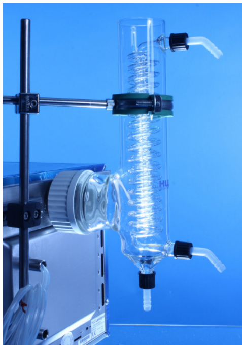
Abbildung: Rückseitig am Mikrowellengerät MW 4000 mit dem Set Haltesystem installierter Kondensationskühler.
