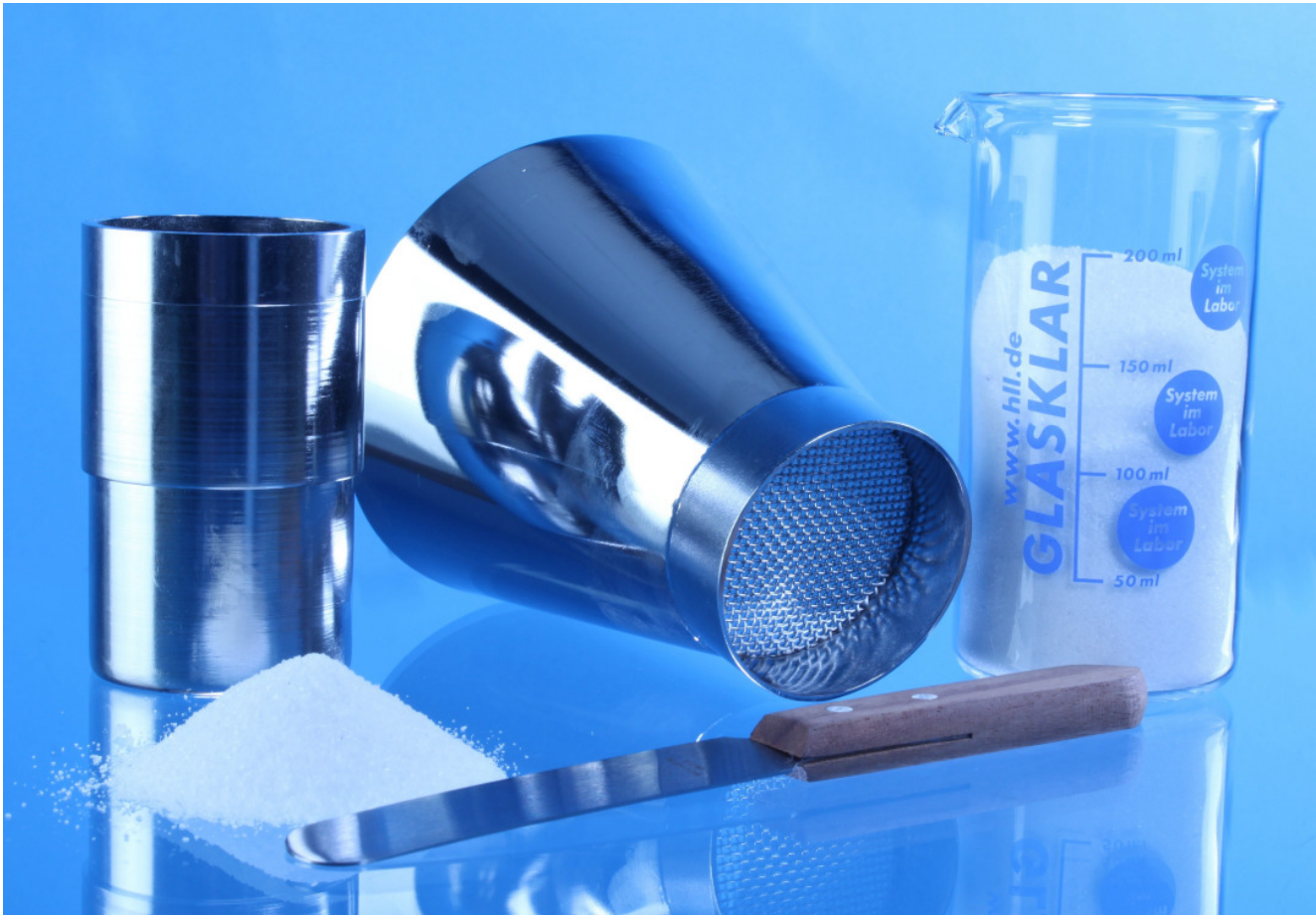
Abb: Messbecher und Distanzring Art. L50566040 inkl. optionalen Siebtrichter Art. L50566040S
