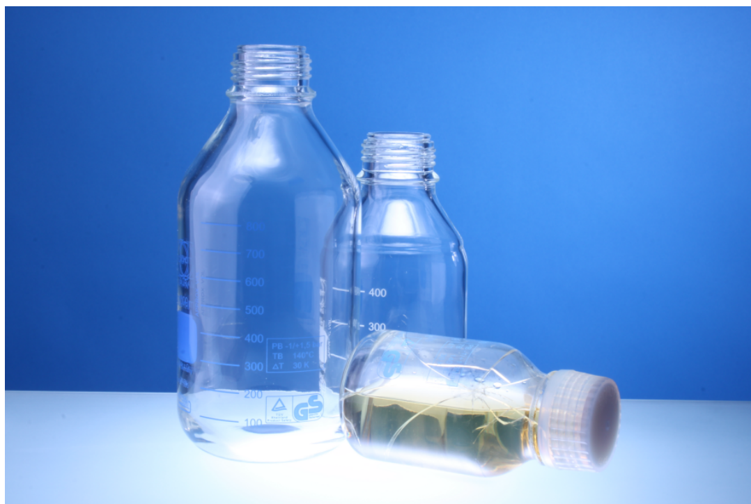
Katalogbild-IMG_7601.JPG Abbildung zeigt die 250 ml Flasche mit aktivierten Auslaufschutz nach einem Sturz aus 1 m Höhe
