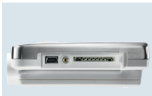
Seitlicher Anschluss von Mini-USB-Kabel und SD-Karte
